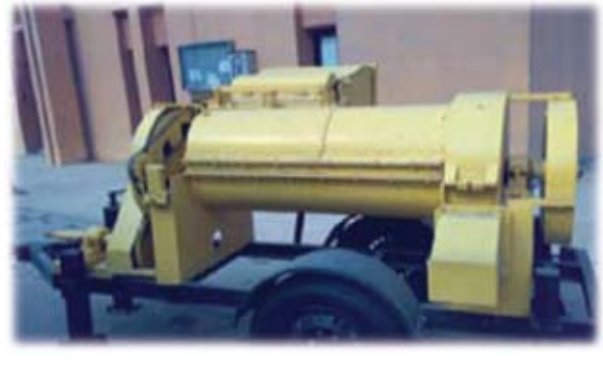
مشروع بحثي لتطوير نظام متكامل متنقل لقولبة المخلفات النباتية في الحقل (حطب القطن وقش الأرز) بالتعاون مع أكاديمية البحث العلمي والتكنولوجيا:
